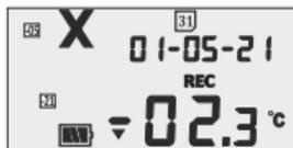
1 小时后，低警报温度持续时间触发警报。显示铃（警报）符号，蜂鸣器触发（声音）。
